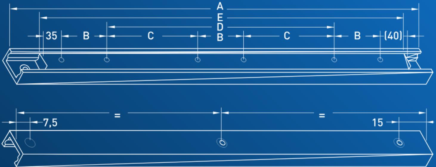
Bis zu einer Einbaulänge von 450 mm entfallen die mittleren 2 Bohrungen
